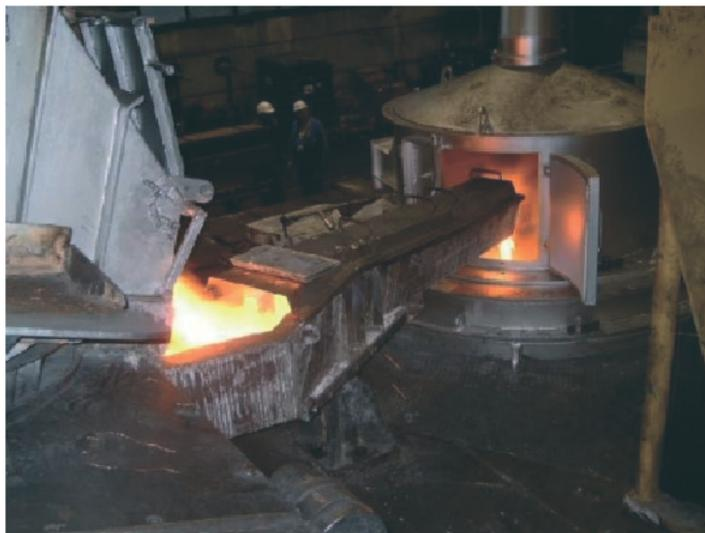
Рис. 42: Печь с укороченной катушкой для выдержки и разливки
