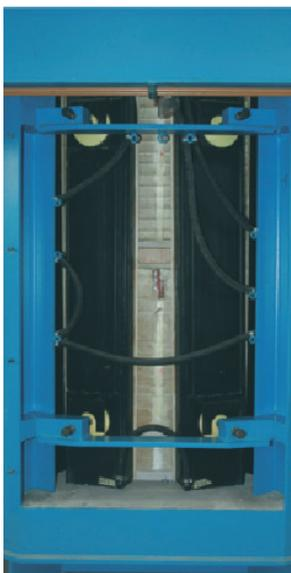
Рис. 27: Виброизолирующий монтаж элементов (жёлтого цвета)
