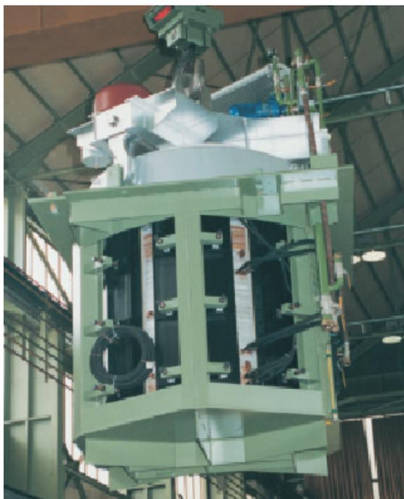
Рис. 43: Устройство горячей смены
