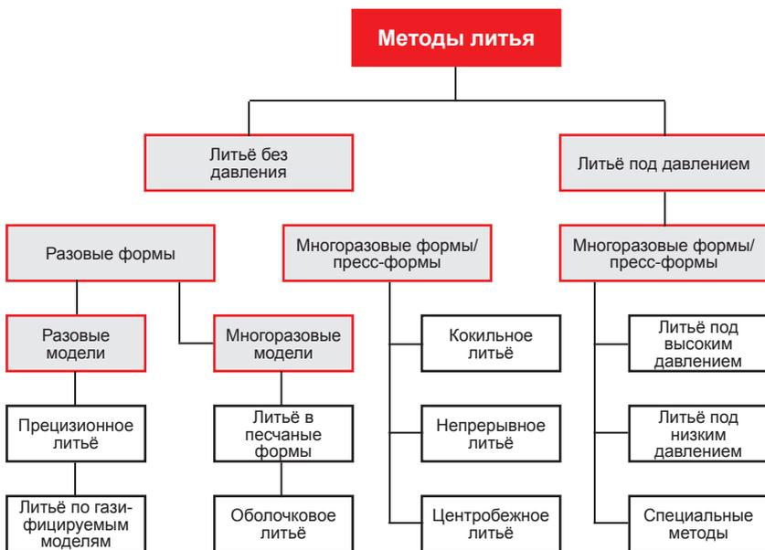
Рис. 4: Методы производства отливок
