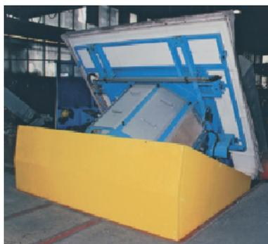
Рис. 25: Защитное ограждение колодца тигельной печи
