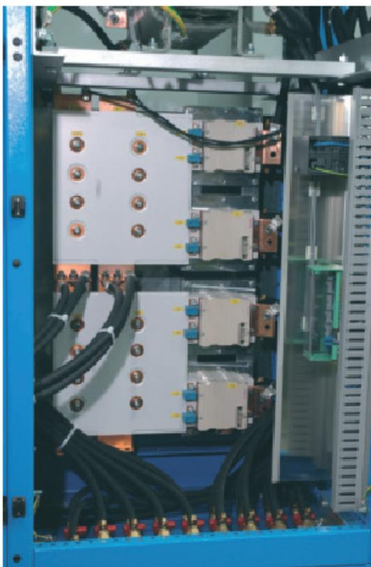
Рис. 19: Модуль преобразователя на базе БТИЗ
