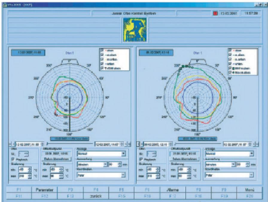
Рис. 24: Оптическое измерение температуры
