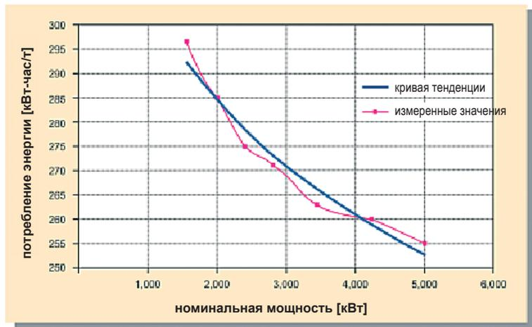
Рис. 39: Зависимость потребления энергии от номинальной мощности 60-тонной канальной печи
