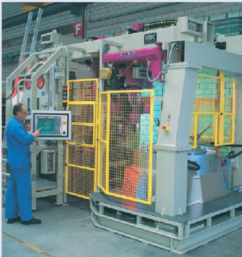
Рис. 51: Современная линия литья под низким давлением для материалов на основе меди
