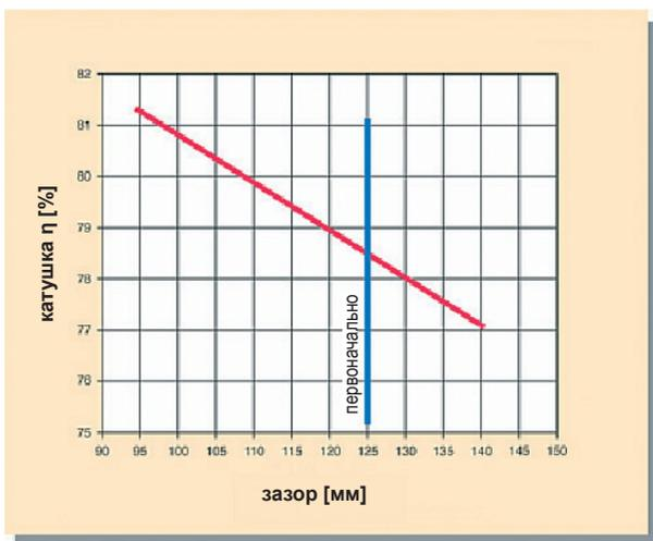
Рис. 37: Соотношение между толщиной футеровки (зазором) и эффективностью катушки
