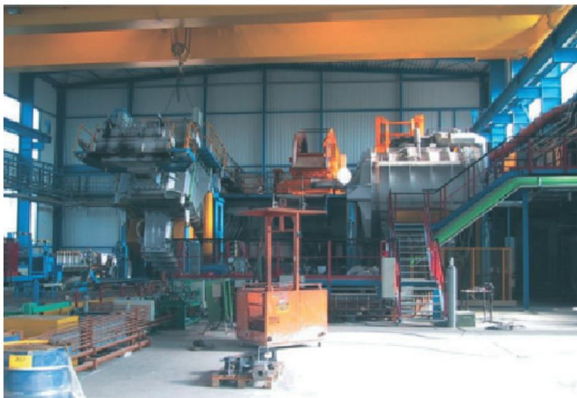
Рис. 41: Система плавки и разливки бескислородной меди
